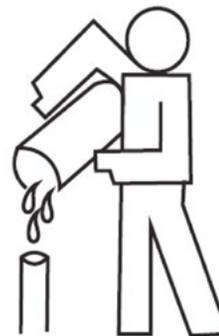
**g)** Si hay agua en el tanque deberá medirla vertiéndola cuidadosamente dentro de la probeta y vaciando esta cada vez que se llene. Cada probeta llena equivale a 50,8 mm más de lluvia. Cuando termine de vaciar el tanque, si la probeta no queda totalmente llena, mida esta agua con la regla, sume y anote.
