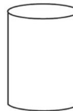
**e)** Tanque cilíndrico: sirve como soporte del embudo y como protector de la probeta. Es el que, además, recibe los excedentes de lluvia cuando esta rebosa la probeta. Este tanque, al propio tiempo, tiene la función de impedir la acción directa de los rayos del sol sobre la probeta, disminuyendo las posibles pérdidas por evaporación.
