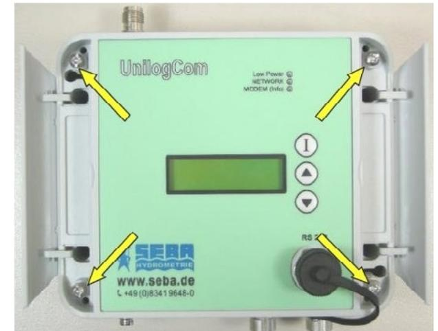
FIGURA 9. UBICACIÓN DE LOS TORNILLOS DE LA TAPA SUPERIOR DEL REGISTRADOR/TRANSMISOR DE DATOS.
