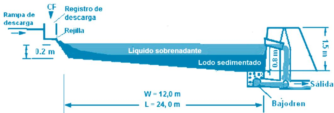
Figura 4. Sección longitudinal de la laguna.
